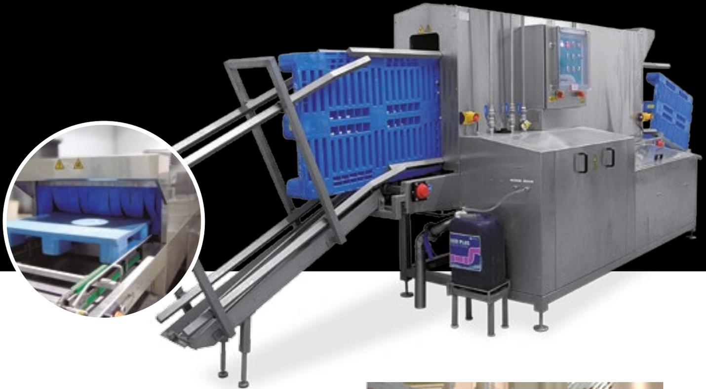
Disponemos de una gran variedad de soluciones para lavar palets, tanto en sistemas tipo "batch" como continuos, en lavado vertical o horizontal y para todo tipo de producciones.
